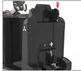
Ergonomik kilit açma kolu ile otomatik bağlama.
